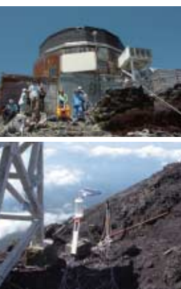
富士山測候所近景 (撮影・提供は表紙 に同じ)と山頂に設 置された雲水採取 装置(大河内博教授 提供)
